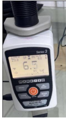
شكل (1) جهاز مستشعر القوة لقياس القوة العضلية
