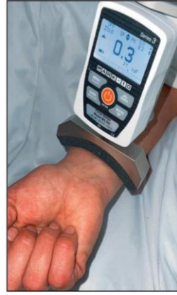
شكل (1) جهاز مستشعر القوة لقياس القوة العضلية
